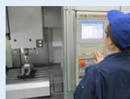
複雑な形状でも、ドリルで穴をたくさんあける長時間の加工でも、プログラミングしておけば、「同じ品質・疲れ知らず」で自動加工します。現場では、「NC旋盤・マシニングセンタ」という加工機が導入されて、そのオペレータとして就職が可能です。さらに複雑なプログラムを作成するなら、「CAM（キャム）」というソフトも学べる内容です。
