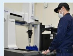
複雑な形状のものを測定する際に、手動での測定では難しいので、3次元測定器という測定器を使用しております。3次元測定器での測定の方法やデータの取り方を学びます。品質管理をする上でも、なくてはならない機械で、使用している会社は増えています。
