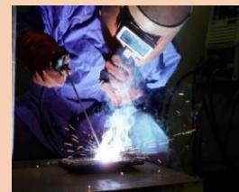
修理や据え付けといった屋外作業(現場作業)によく使われる溶接です。色々な継手や溶接姿勢(向き)の溶接方法を学びます。
