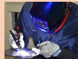
ステンレスの薄板で作られた板金製品や食品機械の部品の接合によく使われる溶接です。主にステンレスの色々な継手の溶接方法を学びます。
