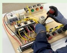
「シーケンス制御」とは、決められた順序通りに動く制御のことです。洗濯機や信号機、工場の生産ラインなど多くの分野で活用されています。スイッチやリレー呼ばれる機器、ランプの間を電線で接続することで、ランプの点灯やモータ動作制御を行う「有接点シーケンス制御」を学びます。
