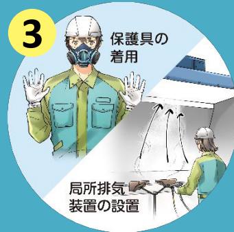
3 保護具の着用 局所排気装置の設置
