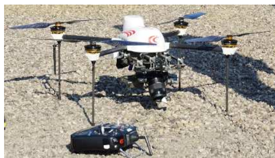
測量用ドローン 前部にカメラが搭載されている。
