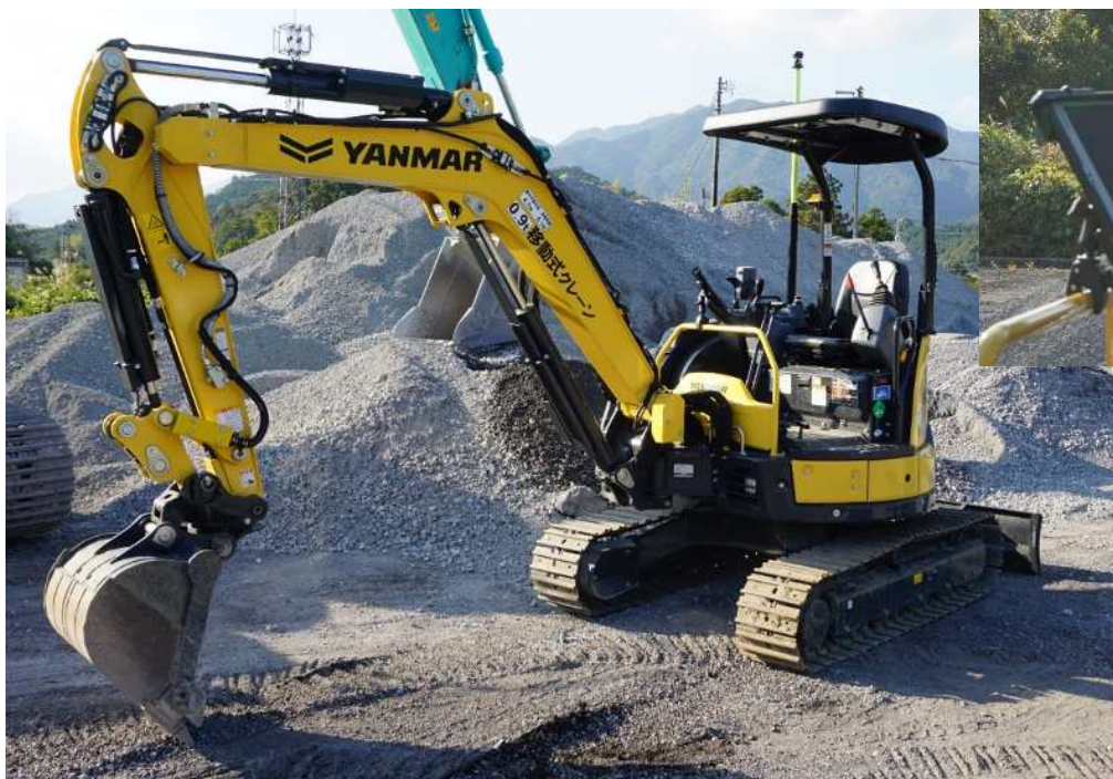
ICT 機器搭載のドラグショベル 運転席に装着されたタブレットに自機の位置や掘削位置、周囲の状況が 3D で表示される。
