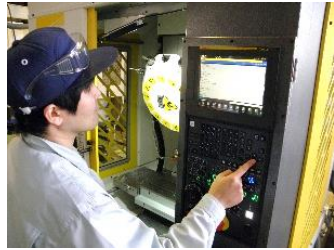
NC旋盤 (マシニングセンタの操作)
