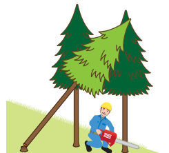
(図3)かかっている立木の伐倒
