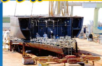
船台にブロックを搭載し建造
