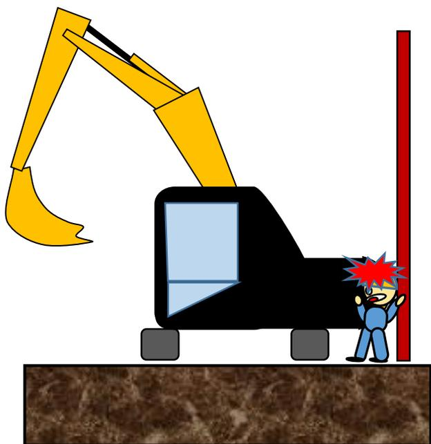
建物の地中梁に打設された均しコンクリートをドラグ・ショベルのバケットで落とそうとしたが落ちなかったため、ドラグ・ショベルから降りて別の作業員の指示に行ったところ、当該均しコンクリートが落下した。
