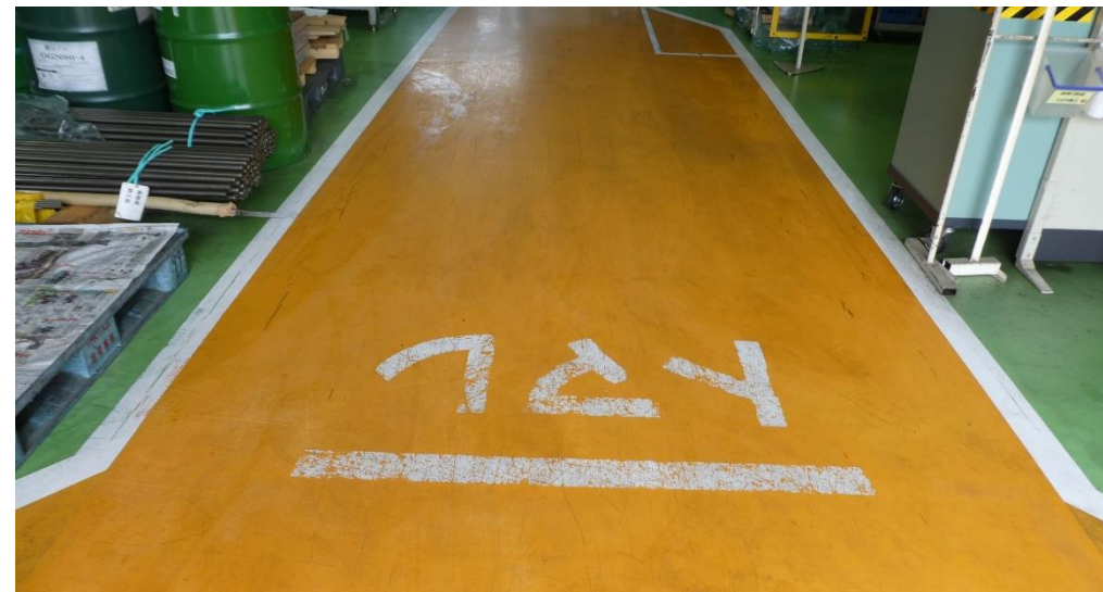
安全通路はオレンジ色、作業場所は緑色で明示
