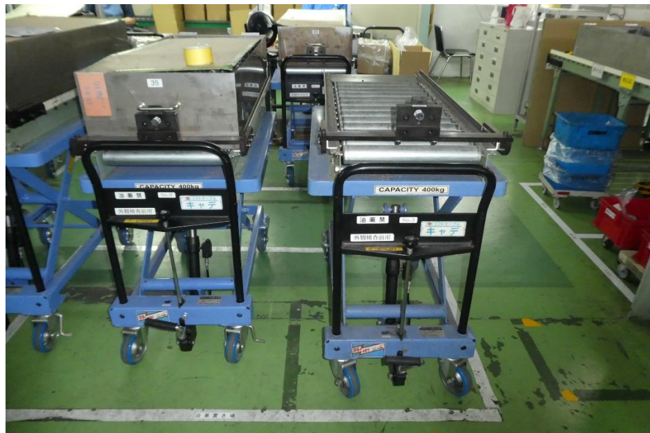
製品搬送用の専用カートを開発し使用
