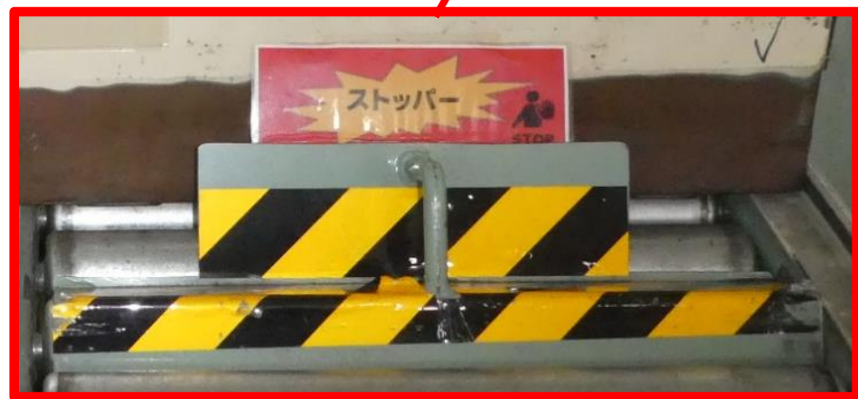
製品搬送用のローラーコンベアを開発。端部にはストッパーを設置。
