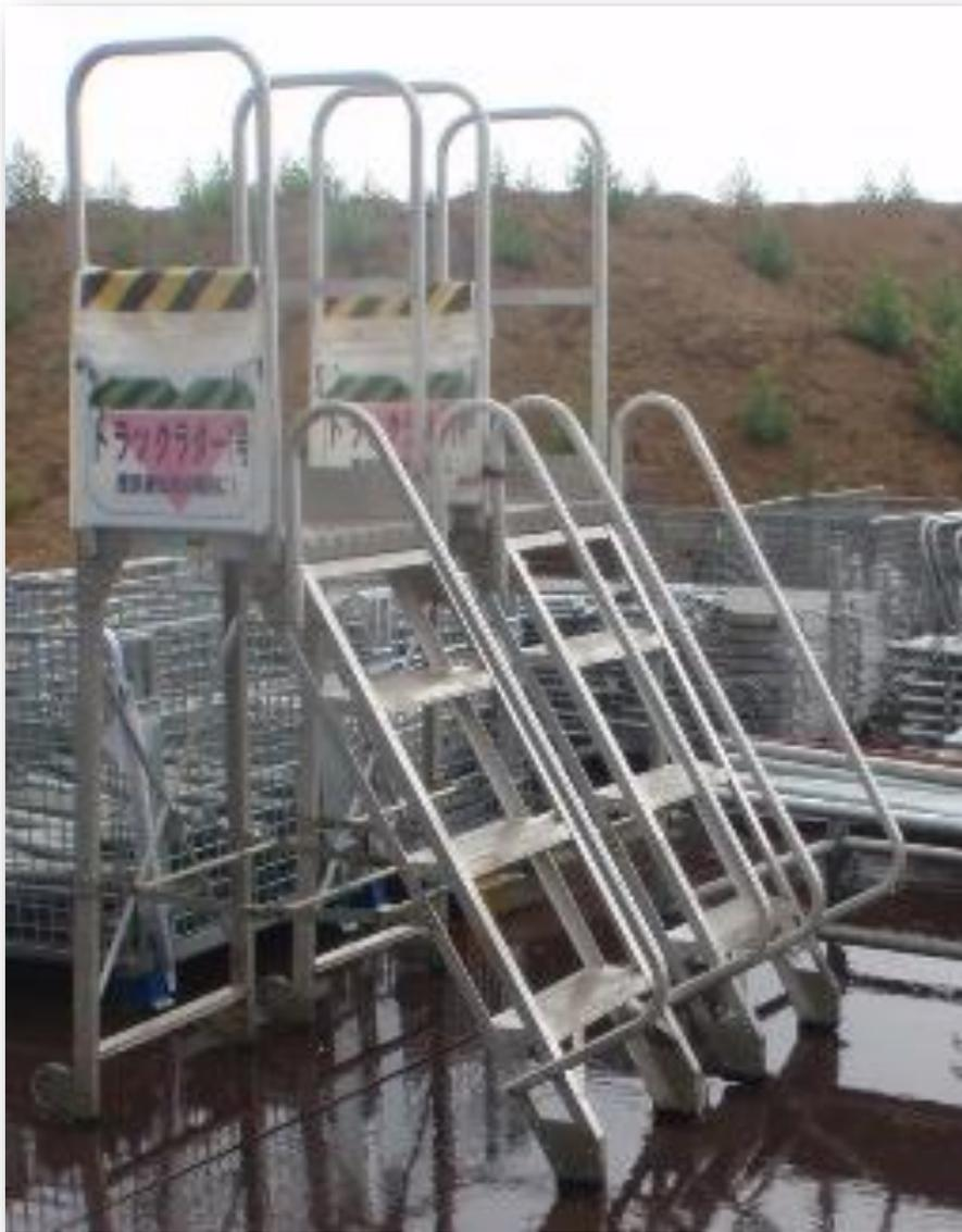
トラック荷台への昇降は、専用トラック昇降ラダーを使用
