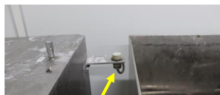
金属に反応するタイプのリミットスイッチ (カバーが開いていると機械は動かない)
