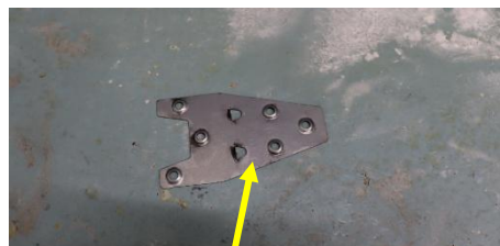
金属片をリミットスイッチに接着 → 機械は安全カバーが閉じられていると認識 → 回転軸が作動する
