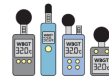
黒球付きのWBGT測定器の例 (購入される際は、JIS B 7922適合、または準拠と表示されていることを確認することが重要です)
