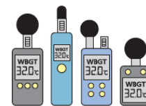
黒球付きのWBGT測定器の例 （購入される際は、JIS B 7922適合、または準拠と表示されていることを確認することが重要です）
