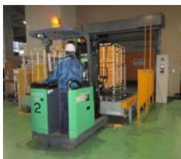
専用パレットをフォークリフトで3Fの自動コンベアを組み込んだエレベーターで1Fに降ろす。
