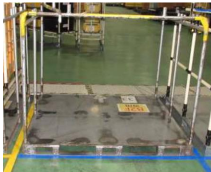
専用パレット(奥側(ピッキング作業場)から勾配を利用しロールボックスパレットを押して入れる。)
