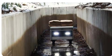
(上) 買取・改修した築60年のビル「チャバタケdoors」を地域コミュニティの場として活用 (下) 地元の大学発ベンチャー企業と協働し、暗渠等の狭い場所を走るロボットの検証実験も行う
