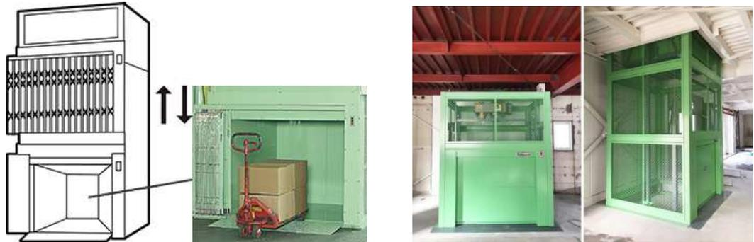
10号 建設用リフト 荷のみを運搬することを目的とするエレベーターで、土木、建築等の工事の作業に使用されるもの(ガイドレールと水平面との角度が80度未満のスキップホイストを除く。)をいう。
