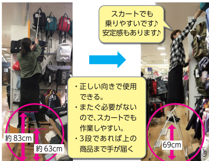
(改善前：脚立) 高さ80cm以下 (改善後：踏台)
