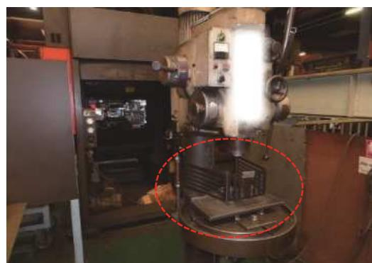
ボール盤のドリル部の周囲に囲いを設け、加工中に作業者の手指等が巻き込まれる災害を防止しているもの。
