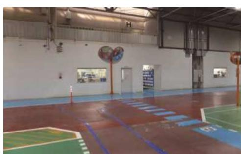
交差点にカーブミラーを設置し、激突災害を防止しているもの。
