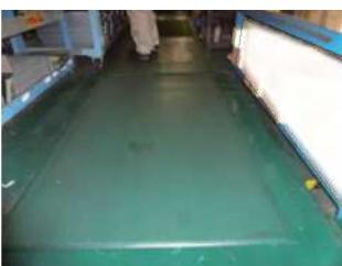
作業場の床面に疲労軽減マットを設置したもの。
