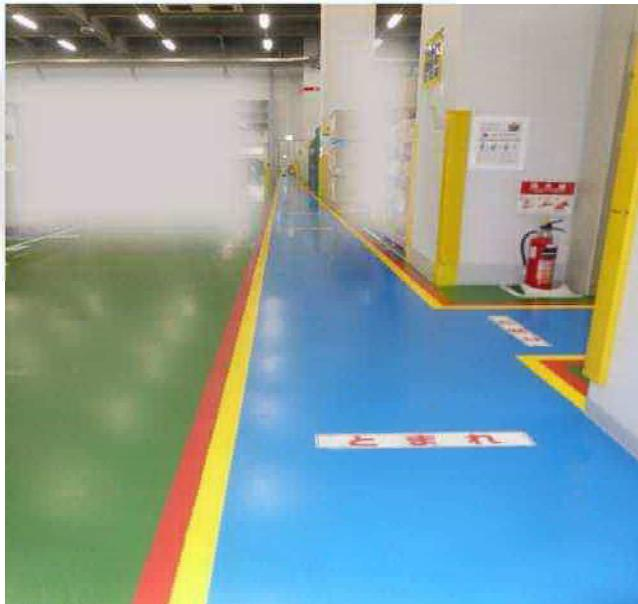
事例の概要 床面を色分けすることにより、台車等の専用通路、歩行者専用通路、資材等の保管場所等を明確にしているもの。また、通路の交差点について、出会い頭の衝突事故等を防止するため、床面に「とまれ」の表示を行っているもの。
