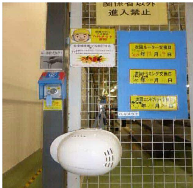
事例の概要 産業用ロボットの周囲に囲いを設けたうえ、キー付きセーフティドアスイッチを設置。さらに、囲い内に入る際には保護帽の着用を義務付け、機械と労働者との激突災害を防止しているもの。
