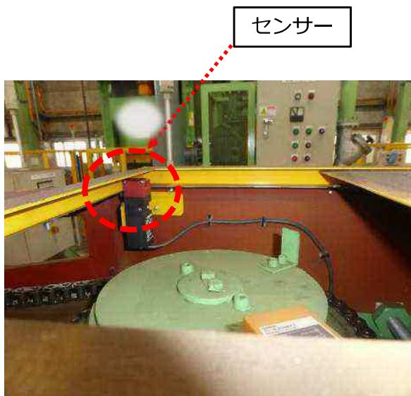
事例の概要 異物等の混入による目詰まり等の状況が一目でわかるよう、側面に覗き窓を設置したもの。天井部のスライド扉にはセンサーが設置されており、稼働中に手指を入れ、駆動部等に手指が巻き込まれる災害を防止しているもの。
