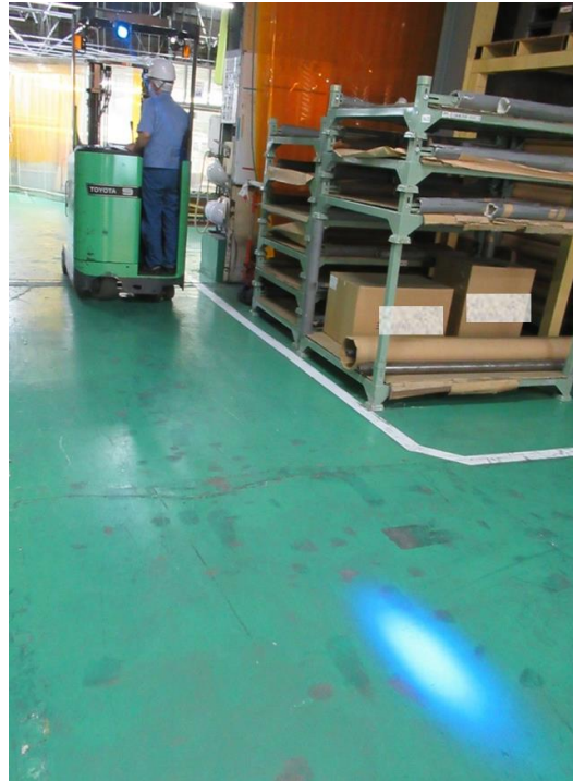
進行方向を照射する装置を 設け、人が危険範囲内に立ち 入ることを防止している。 (p17)
