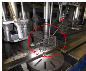
ボール盤のドリル部の周囲に囲いを設け、加工中に作業者の手指等が巻き込まれる災害を防止しているもの。
