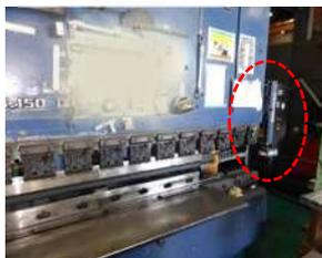
プレスブレーキ用レーザー式安全装置を設置し、作業者の手指等が金型に挟まれる災害を防止しているもの。
