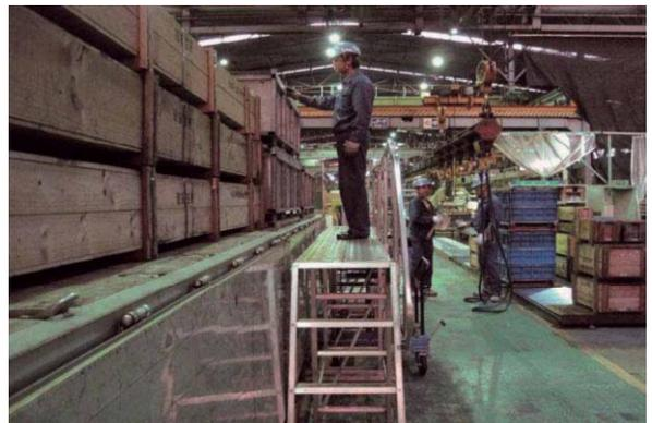
荷台の両横に移動式の作業床(架台)を設置
