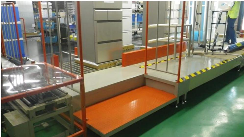
冷蔵庫送りローラー上に歩幅間隔で作業踏み板を設置し、段差・開口箇所の封鎖や、進入禁止柵を設置するなどによる転倒防止対策を推進。
