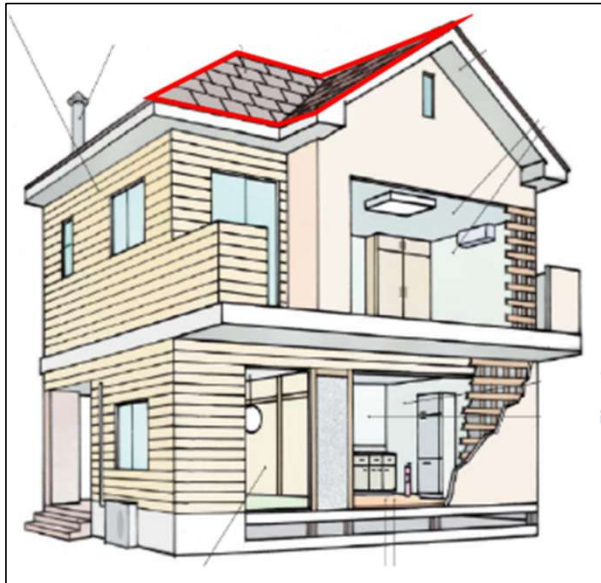
図-3-20：石綿含有住宅屋根用化粧スレートの取付場所
