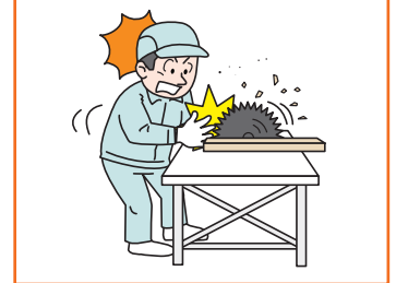
丸のこ盤の刃に 手が触れそうになった
