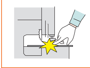
シャーリングマシンで 指の先を切断した
