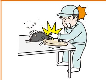
切断中の板が上下にあおり出したので、板を押さえたとき左手の小指が刃部に接触してケガをした。
