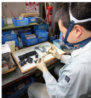
家内労働者には、金属のパーツに接着材を塗布し、ゴムを貼り合わせる作業を委託しています。指の感覚で微妙なズレを修正し、適切な力で圧着しなければならない大変手間のかかる作業です。(写真は社員による実演)
