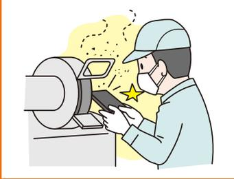
鉛を含有する鋳物部品の切断・研磨に長年従事、腹痛で受診したところ慢性鉛中毒と診断された。
