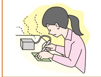
換気が不十分な作業場でハンダ作業に従事、血液検査で慢性鉛中毒と診断された。
