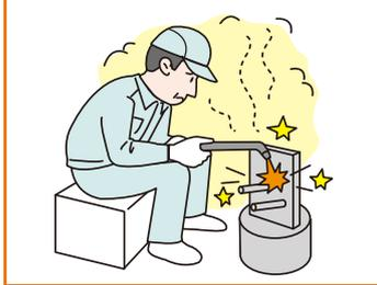
含鉛塗料が塗布された鋼材のガス溶断後、数日間体調不調が続き受診、急性鉛中毒と診断された。
