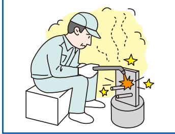
含鉛塗料が塗布された鋼材の溶断で鉛中毒
