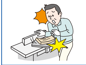
手押しかな盤で作業中 材料が跳ねて被災
