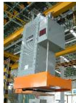
自動配湯装置
