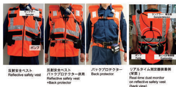
トンネル建設工事現場での粉じん測定における反射安全ベストおよび背中用保護具 (バックプロテクター) 着用時の個人ばく露測定機器装着方法の検討 Optimization of personal sampler mounting onto a reflective safety vest and/or back protector for tunnel construction workers.
