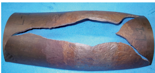
減肉鋼製配管の破裂試験
