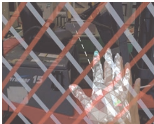
MR(複合現実)技術によるフォークリフトへの人の接近情報の提示 Alert indication of approaching hand to forklift using MR
