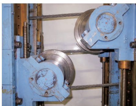
ワイヤロープのS字曲げ疲労試験
