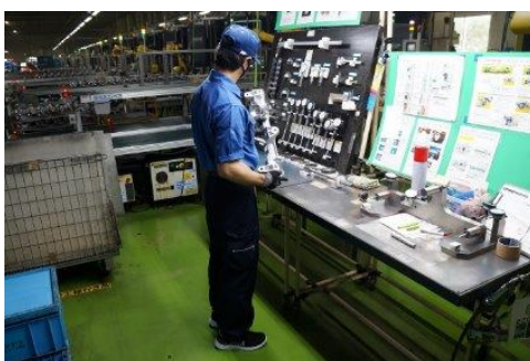
●加工後の製品の寸法測定及び目視検査
