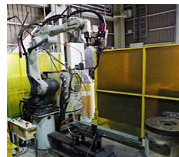
溶接ロボット
