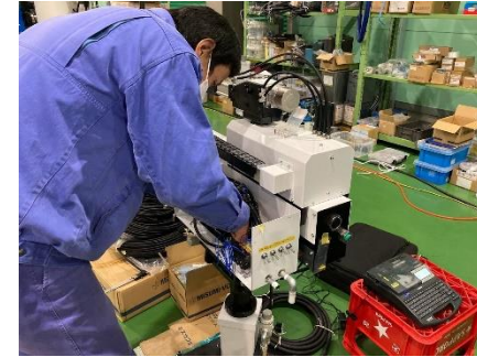
取り出し機の組立て中
