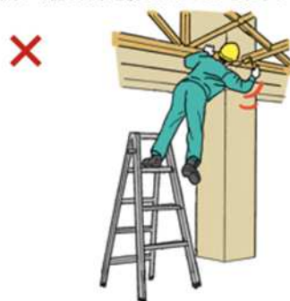
図3-16 脚立の設置位置が不適切
