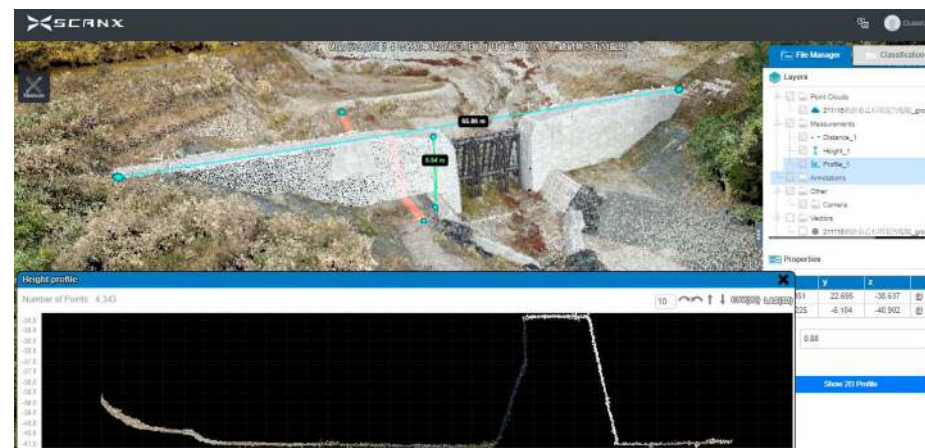
ドローンを活用した点群（計測可能）
