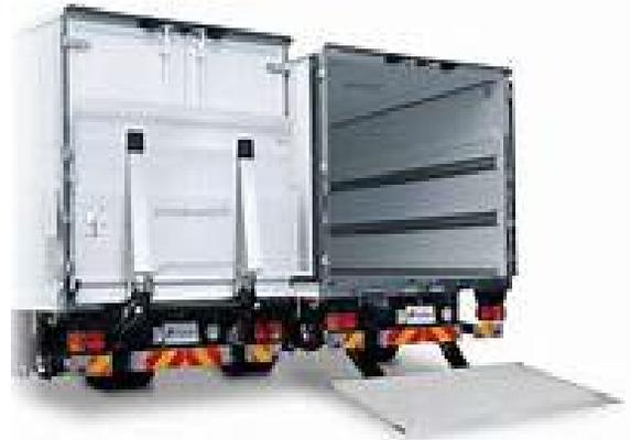
A1 後部扉を開けた後、テールゲートリフターを使用して荷の積み卸し作業を行う場合、**特別教育が必要**（単に扉を開けるためにテールゲートリフターを操作するものではないため）。
