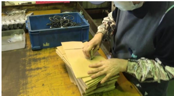
①段ボール箱を必要数準備し、工事番号 スタンプを押印する
