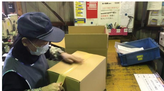
⑥収納箱の隙間に緩衝材を詰め、テープ で封をする
