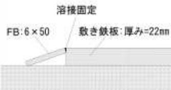
敷き鉄板端部を平滑になるようフラットバーを溶接固定
