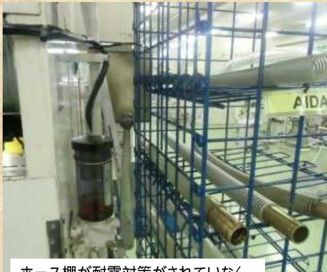
ホース棚が耐震対策がされていなく、地震や、台車等の接触による棚の転倒の危険性大。
