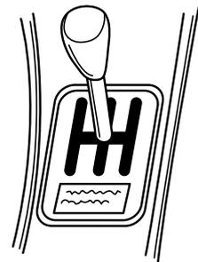
シフトレバー付近に注意喚起のシールを貼ることで、車外の忘れ物やギアチェンジ時の誤操作防止を図っている。
