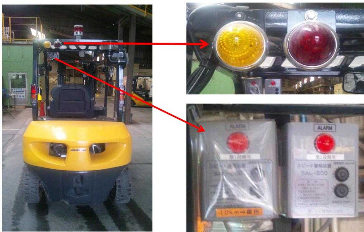
事例 32 フォークリフトにスピード警報装置を設置。2段階(10km/時、20km/時)の設定速度を超えると運転席の警報ランプが点滅するほか、車体後部のランプが点灯し運転手以外の作業者に走行速度を可視化している。
