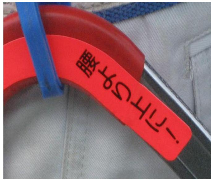
**事例 54** 安全帯フックに蛍光マーカーを貼付することで、作業者の安全帶着用が他の作業者からも確認しやすくしている。また、適切な高さにフックをかけるようにコメントを入れることにより、安全な使用方法を徹底している。
