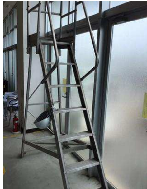
本来こちらの高所作業用踏台を使用
