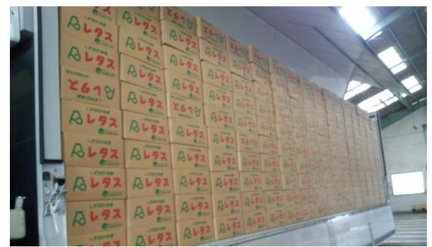
10トン車に、レタスのバラ積み1,200ケース分(1ケース7～10kg程度)のダンボールを手積み・手降ししている事例
