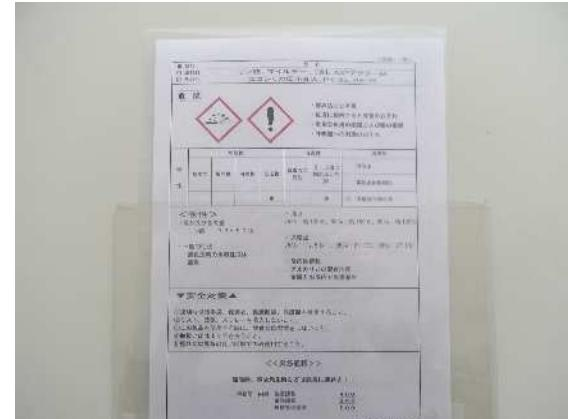
SDSをもとに情報カードを作成し、現場の化学物質使用箇所付近に対象の情報カードを掲示することで、使用する化学物質の危険性、有害性などの化学的物性、漏洩時の処置等の緊急措置が視覚的にわかるようにした。
