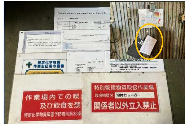
溶接作業に必要な掲示物をラミネート加工し、1つの束としてまとめて、どこでも溶接作業をおこなう事ができるようまとめて持ち運べるようにした。
