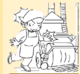
機械の清掃中に手巻き込まれそうになった
