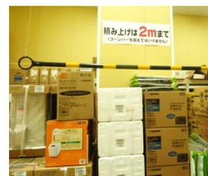
▲バーで、積み上げ高さを制限している見える化事例
