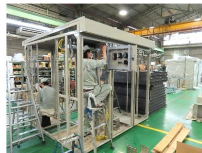
キュービクル組立作業
