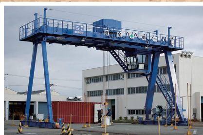
▲橋形クレーン実習風景
