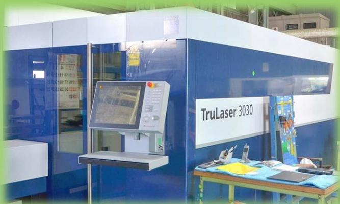
高性能高速レーザー加工機
