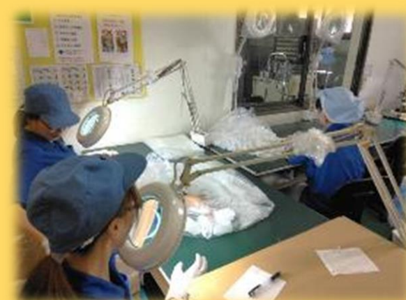
拡大鏡使用した検査の様子
