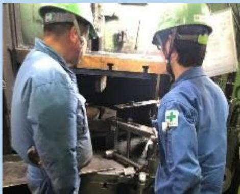
「熱間鍛造」は鉄などの材質を1000℃以上の高温に加熱して成形する加工法ですが、夏と冬では気温の差が大きく異なり、品質に大きく影響します。
